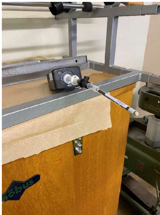
Figur 7. Bild över provtagningsutrustning för inomhusluft.
