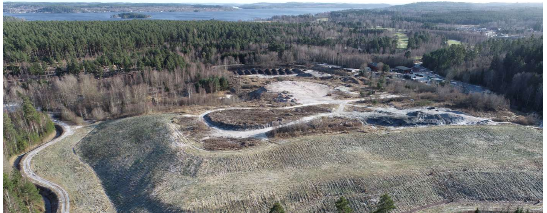
Drönarfoto tagen från områdets nordvästra sida med vy över de sluttäckta slänterna i förgrunden samt komposthögar och ÄVC längre bort i bild (2023).
