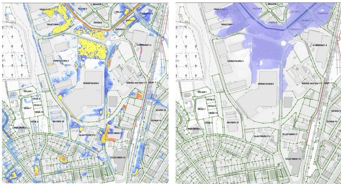
Figur 6 & 7: till vänster, utdrag ur kommunens skyfallskartering (max djup totalt). Till höger, utdrag ur översvämningskartering (beräknad högsta flöden BHF)
